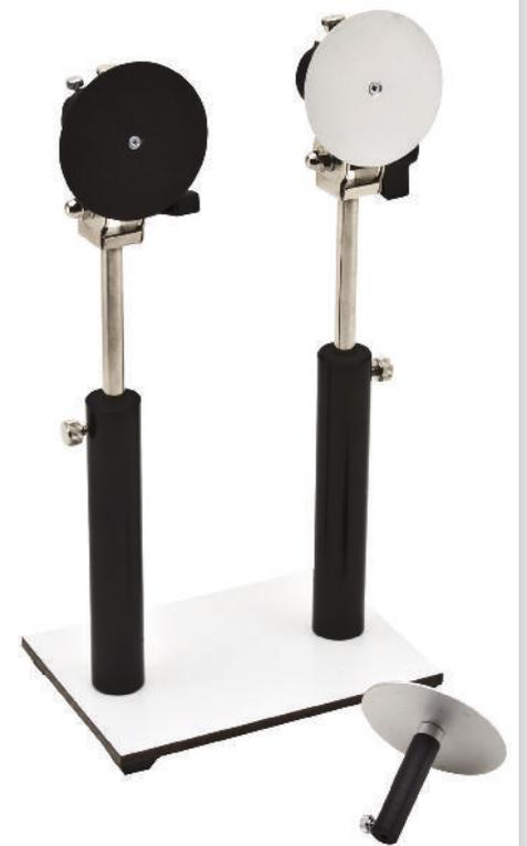
Due dischi di alluminio identici, uno dipinto di nero e l'altro lucido, sono esposti alla luce di una lampada da 100 W. Un sensore di temperatura posto su di essi dimostra che il coefficiente di assorbimento del disco nero (linea verde) è maggiore di quello del disco lucido (linea rossa).
