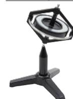
Ruota giroscopica in metallo. Mettendola in rapida rotazione per mezzo di una cordicella, si può verificare la conservazione del momento angolare. Se si applica una forza perpendicolare all'asse di rotazione, è possibile osservare il fenomeno della precessione, ovvero l'effetto giroscopico.
