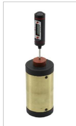
Il cilindro calorimetrico di ottone può essere facilmente montato e smontato.
