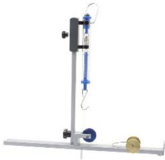
E' costituito da una rotaia sulla quale può scorrere un carrello a basso attrito. Mettendo in rotazione l'apparecchio è possibile leggere sul dinamometro il valore della forza centrifuga, ed è possibile verificare la formula della forza centrifuga.
