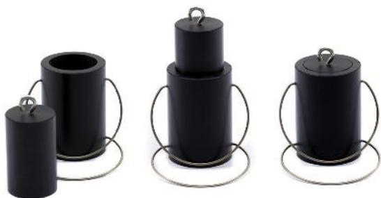
Cilindro cavo (misure esterne):  $h = 60$  mm;  $d = 41$  mmCilindro pieno:  $h = 50$  mm;  $d = 30$  mm
